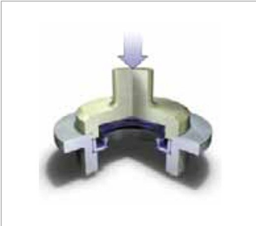
Abb. 45 Montage mit hydraulischem oder pneumatischem Einpressstempel. Durchmesser des metallischen Anschlags 5 mm bis 10 mm größer als Außendurchmesser ( d_2 ) der Dichtung
