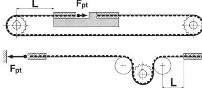
Transmission simple à deux axes / Two Pulley Drive / Einfacher Zwei-Achsen-Antrieb
