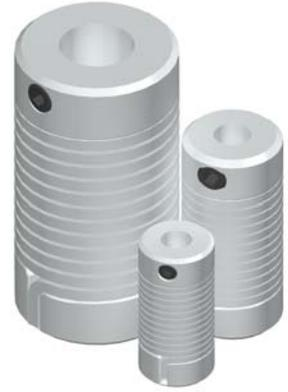
SPRING-FLEX-Kupplungen basieren auf der Verwendung einer zylindrischen Schraubenfeder als elastisches Übertragungselement. Diese Schraubenfedern sind aus Stahl gefertigt und mit flachem Querschnitt. Die Endbereiche der Feder sind so entworfen, dass ihre Drehung vermieden wird. Das Ergebnis ist eine Kupplung mit großer Elastizität, die eine Verbindung von stark versetzten Wellen erlaubt, ohne dass dabei sehr große Belastungen auf die Lager wirken. Die Kupplung behält
