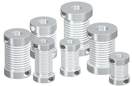
Die BELLOW-FLEX-Kupplungen basieren auf der Verwendung von flexiblen Metallbälgen, die das Drehmoment übertragen können, Ausrichtungsfehler kompensieren und sich dabei kaum durch Torsionselastizität verformen. Dank ihrer Eigenschaften bieten die BELLOW-FLEX-Kupplungen eine sehr genaue Übertragung des Drehmoments selbst bei großen Kräftepaaren und hohen
