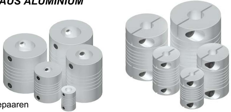
Die Modelle ALU-FLEX sind einfache einteilige Gelenkkupplungen aus einer gehärteten und mechanisch bearbeiteten Aluminiumlegierung. Sie eignen sich für Bewegungsübertragungen mit gemäßigten Kräftepaaren und bei nicht allzu großen Falschrichtungen an den Wellen. Bei überhöhten Kräftepaaren wirken sie wie eine mechanische Sicherung. Diese Kupplungen sind besonders für Mess- und Kontrollsysteme sowie für Antriebe mit
