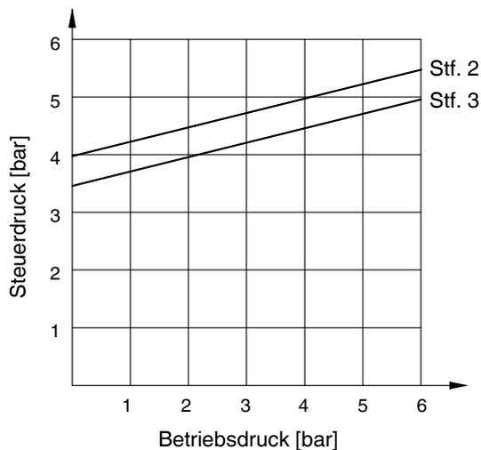
Der im Diagramm abgebildete Steuerdruck in Abhängigkeit des vorherrschenden Betriebsdrucks dient hier zur Orientierung für einen membranschonenden Betrieb.
