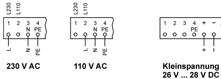
**i** Beim Betrieb der Filtersteuerung an Kleinspannung, wird ein separates Netzgerät empfohlen. Das Gerät kann mit einer Versorgungsspannung von 24 V DC betrieben werden, wenn keine Erweiterungs-Module angeschlossen sind und wenn die elektrischen Leitungen (Mindestquerschnitt: 0,75 mm<sup>2</sup>) zu den Magnetventilen kürzer als 10 Meter lang sind.
