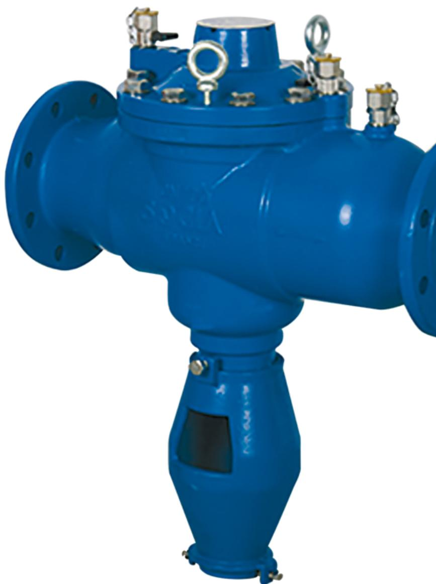
Il disconnettore a zona di pressione ridotta controllabile BA 4760 prevede tre zone di pressione distinte (a monte, intermedia e a valle), due valvole di ritegno indipendenti che separano la camera intermedia dalle altre (normalmente chiuse in assenza di flusso) e una valvola di scarico (all'aria aperta) nella zona intermedia, normalmente aperta in assenza di flusso.
