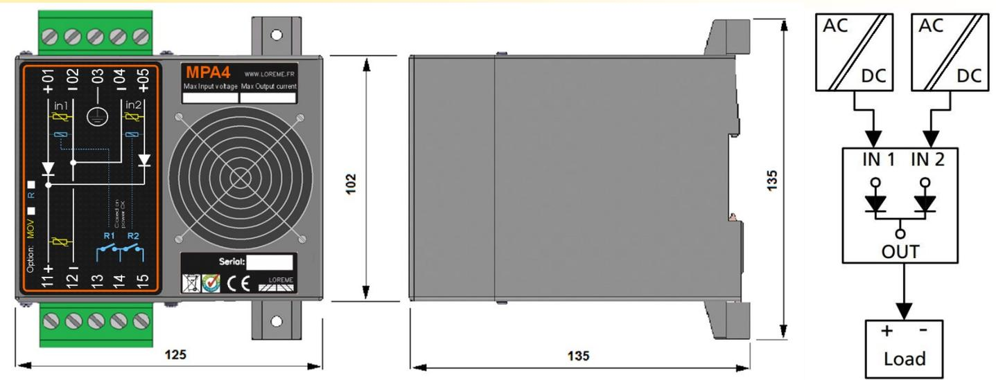
**REDUNDANCY MODULE with DIODE: MPAx**
